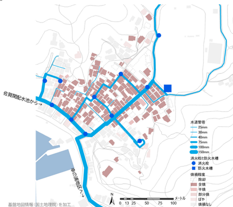
図 2-16 被災地域付近の水道配管 大分市消防局提供資料から作成
