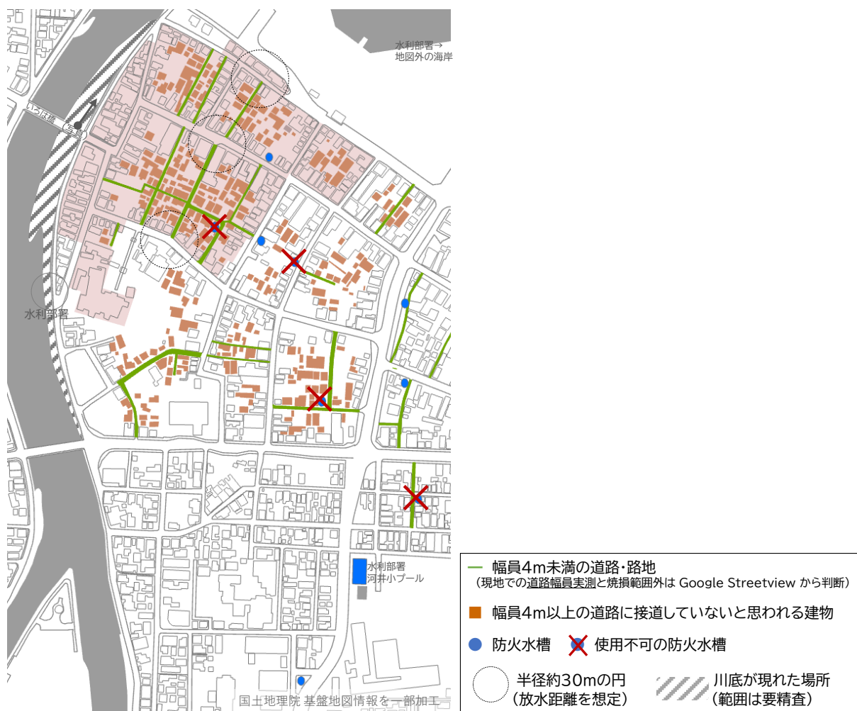
図4-2 市街地の状況と防火水槽
