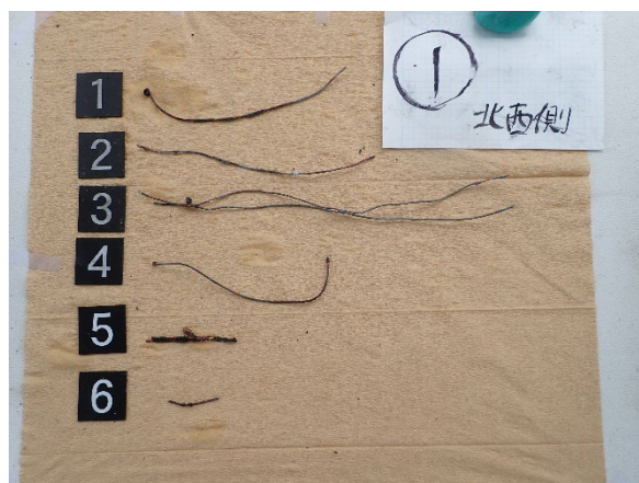
【写真5-8 電気配線の溶融状況】
