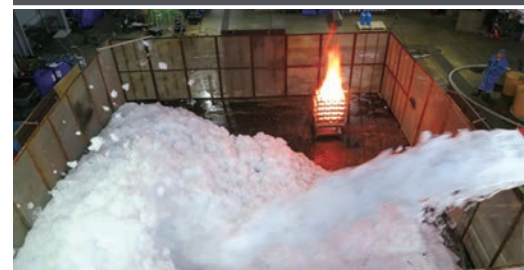
倉庫火災に対する消火手法の検討 泡消火の実験
