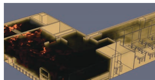
科学技術で火災予防 火災シミュレーション（CFDによる火災現象の解明）
