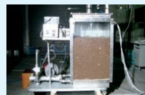
ゴミ処理設備の爆発再現実験
