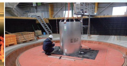
危険物施設の安全性向上のために 石油タンクの振動台実験
