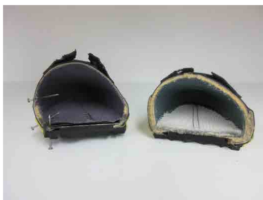
従来の防火靴 (左) と試作した踏抜き防止防火靴 (右) のカットモデル (P.139)
