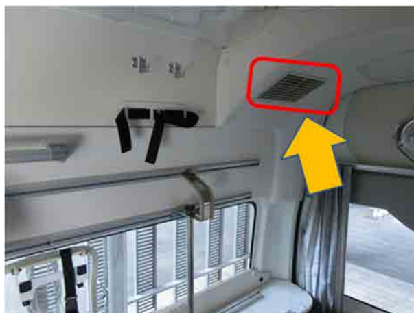
図 23 換気扇（救急車後部）
