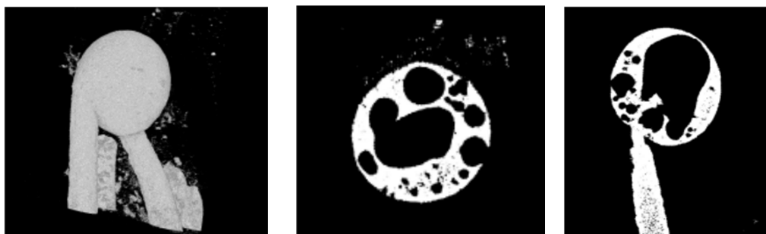
図 2 溶融痕を白色 X 線 CT 測定後に解析した結果の例 (切り取った状態で通電により作成した試料、 左から立体表示、横方向の断面図、縦方向の断面図)
