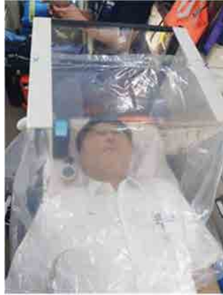
図 30 実験時の状況（傷病者役が気流制御バージョン内で横たわった状態）
