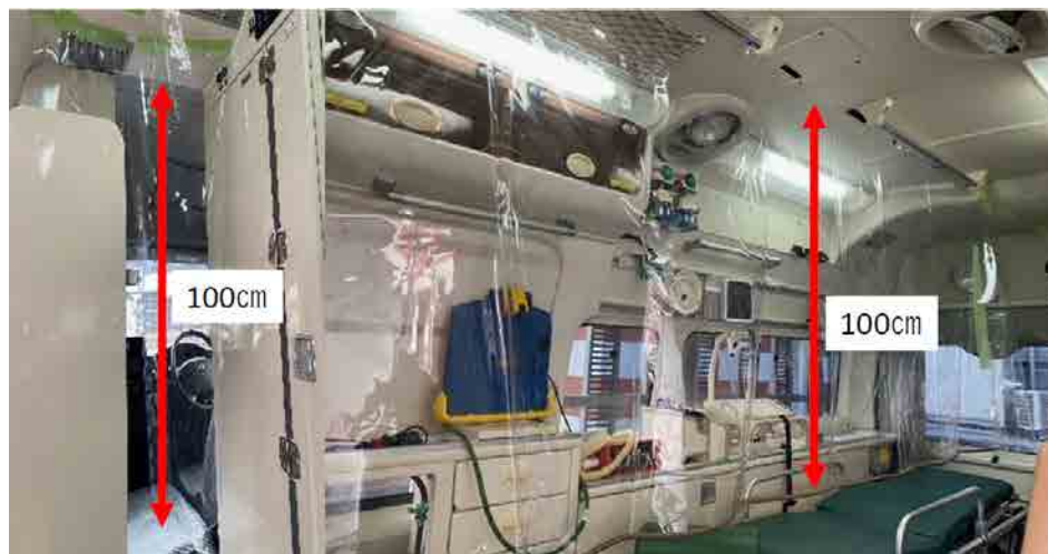
図 17 救急車天井に取り付ける仕切りカーテン
