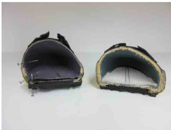
図1 従来の防火靴（左）と試作した踏抜き防止防火靴（右）のカットモデル
