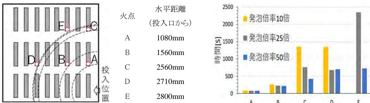
図 26 仮想火点のレイアウト及び各発泡倍率の仮想火点までの到達時間
