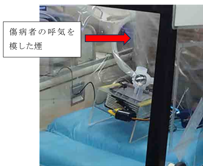
図21 傷病者の呼気を想定した実験装置
