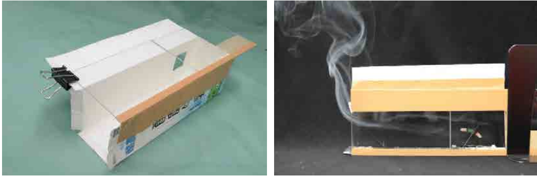
写真1 牛乳パックを使った簡易燃焼区画 (左：内部観察用にガラス板を使用、右：線香を使った気流観察)
