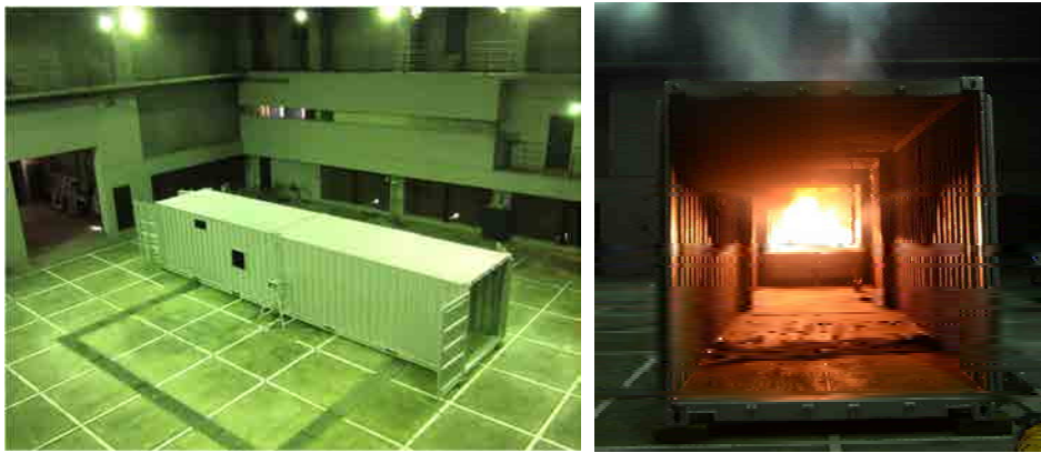
写真2 消防隊放水実験用区画 (左：実験区画の設置状況、右：燃焼実験中の状況)
