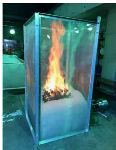
写真3 泡発砲装置を用いた消火実験
