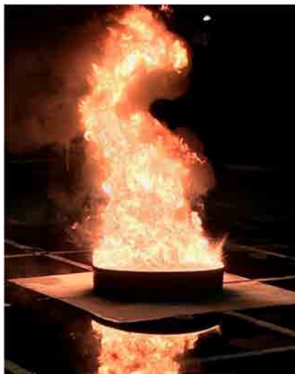
写真2 軽油の燃焼実験
