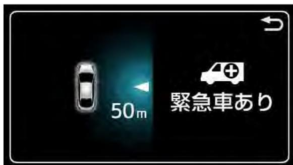
図 10 ITS Connect (緊急車両存在通知)
