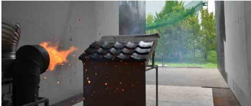
図 16 日本瓦を対象とした実験の様子
