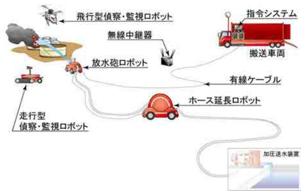
図3 消防ロボットシステムの活動イメージ
