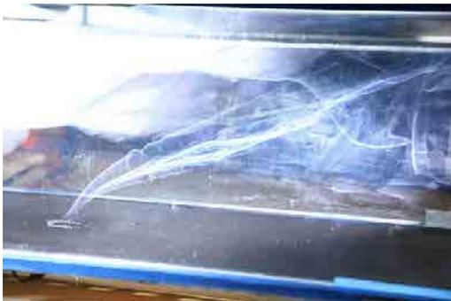
写真5 火災旋風の可視化実験
