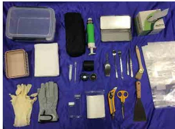
図 11 試料採取用キットの例
