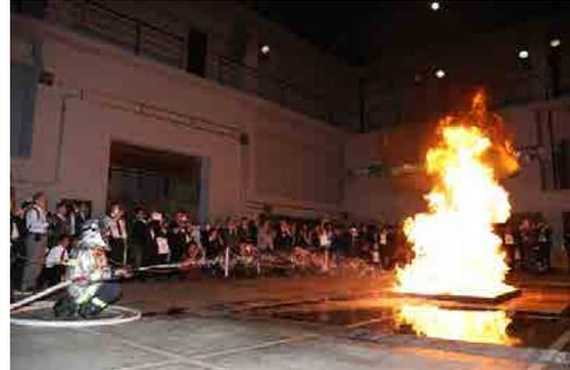
写真2 可燃性液体火災の泡消火実験
