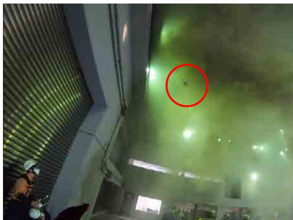
図3 煙の中での飛行実験状況
