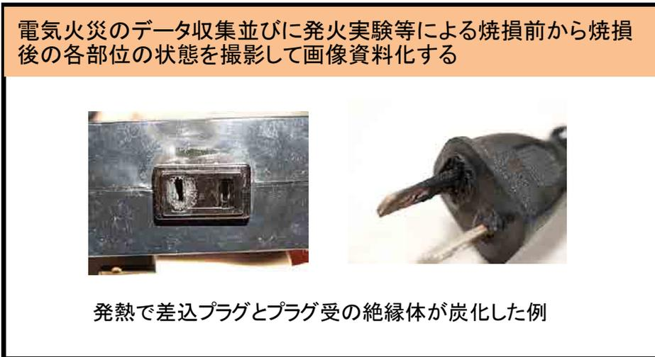
電気火災の原因となった機器のデータを収集し、発火実験等により焼損前から焼損後の各部位の状態を画像資料に整理しデータベース化する
