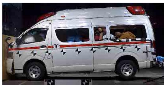
図 12 救急車衝突実験状況(前面衝突)
