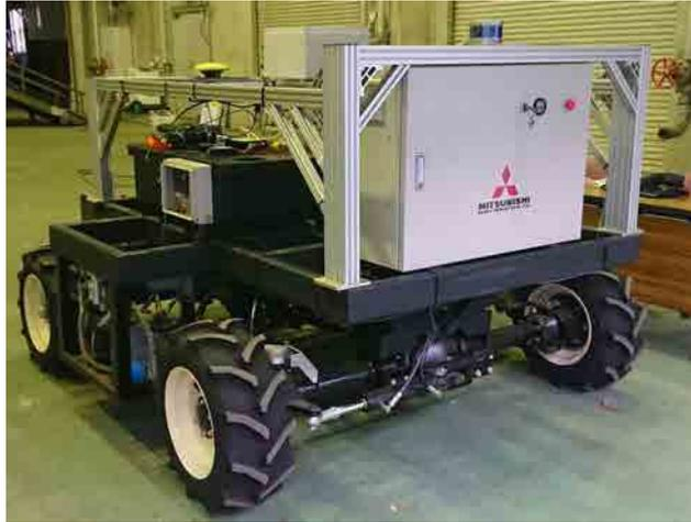
図7 検証実験に使用した台車：前方上部中央に新型レーザースキャナを搭載
