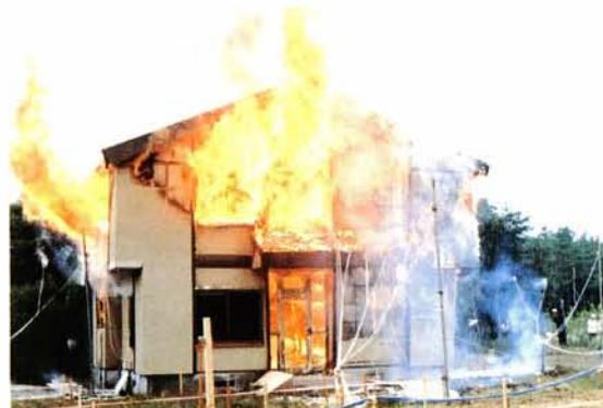
5. A棟の燃焼状況（点火後51分、火災最盛期）
