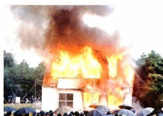
6. C棟の燃焼状況（点火後28分、火災最盛期）
