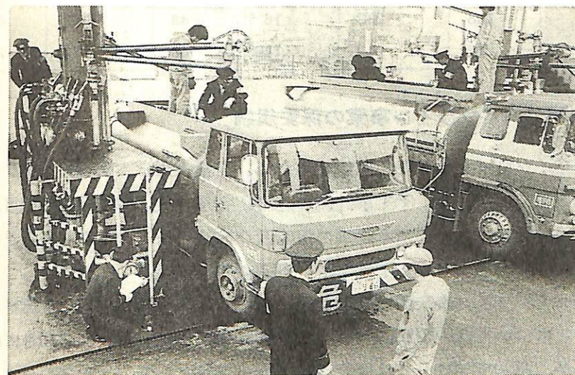
移動タンク貯蔵所(タンクローリー)の立入検査(東京消防庁)
