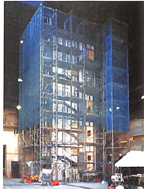
実物大モデルを使った5層階段室火災実験
