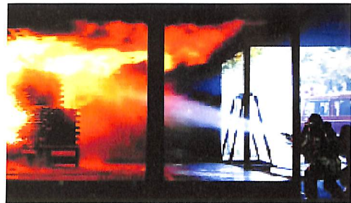
2流体方式のウォーターミストノズルによる消火実験
