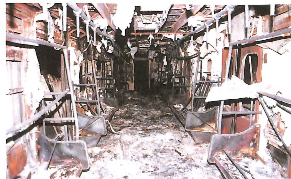
車両内部の延焼状況
