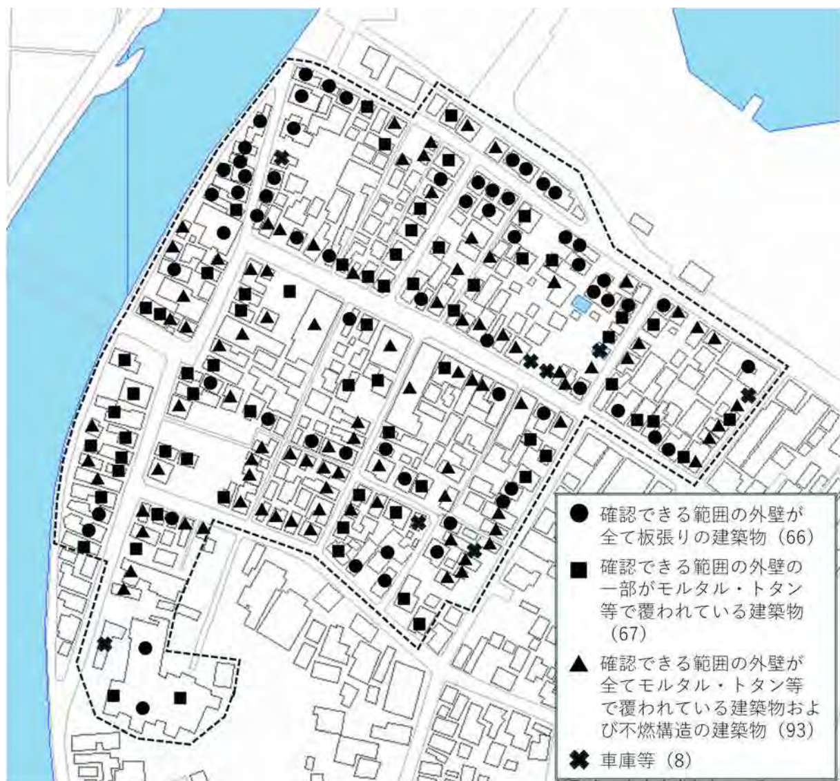
図4 Google ストリートビューに基づく焼失範囲内建築物の外壁分類結果
