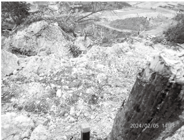
図19 珠洲市仁江町の土砂の様子（2月5日）。風化した砂を主体とする。手前の赤い杭は最後に行方不明者が目撃された場所（の直上）を示すとのことであった。
