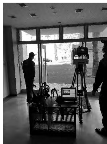
写真5 検知器の設置状態 (俯角が0°の場合)
