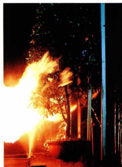
カラーグラビア10 注水による樹木の燃焼抑制の状況 (火炎が接近する箇所に重点的に注水すれば樹木の燃焼を防止できる)
