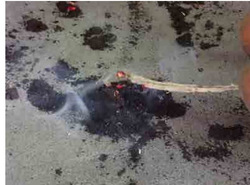
写真11 赤熱した堆積物に可燃物を接触させた状況
