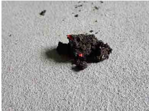
写真10 煙突内の堆積物の燃焼状況 （接炎して離れた後の状況）
