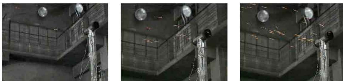
写真 9 火の粉の飛散状況の例 左：極小、少 中央：中 右：多
