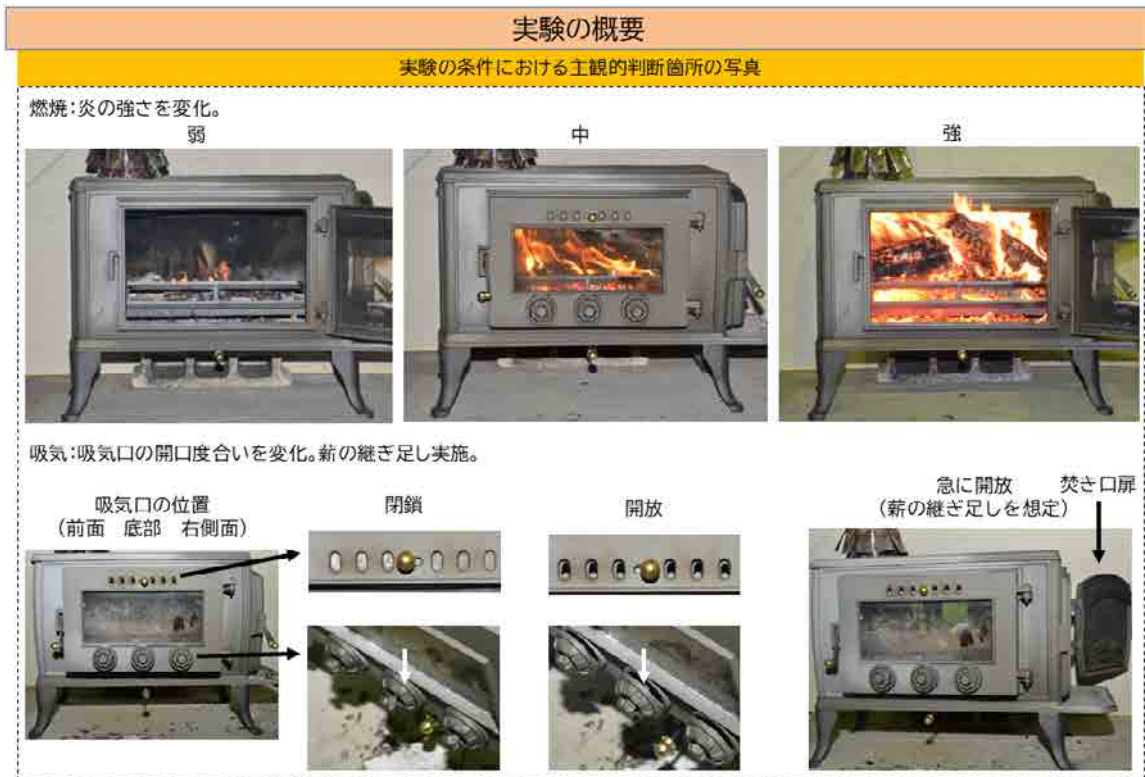
写真8 実験条件 燃焼の強さ及び吸気口の開口度合い
