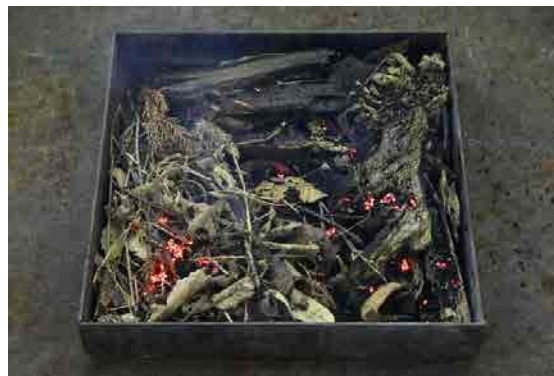
写真12 火の粉の着火状況
