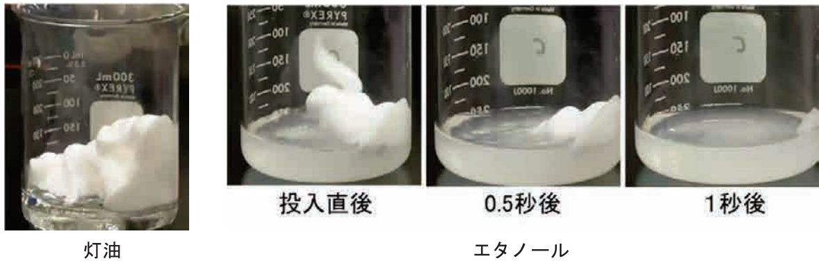
図7 引火性液体の入ったビーカーに手洗い用泡石鹼の泡を投入した状態
