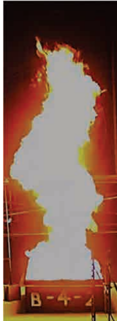
図9 開放された空間でのヘプタン火皿の燃焼（面積 0.8 m 2 の方形）
