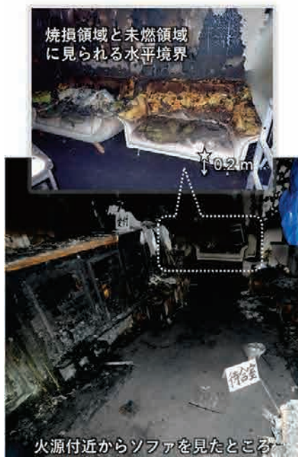
図 10 待合室に設置されたソファへの放射熱流束（★の位置）
