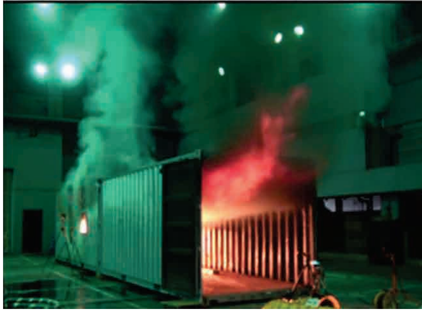
図 11 長さ 12 m のコンテナ区画内で 1.6 m 2 のヘプタン火皿を燃焼 （開口部は手前側のみ）
