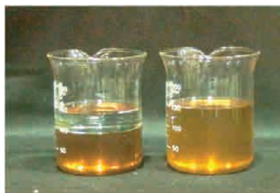
図3 引火性液体に着色した水を加えて混ぜた状態 （左：非水溶性液体、右：水溶性液体）
