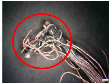
【写真 25 白色配線（可動部側）】
