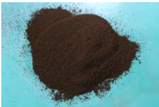
写真 19 集塵機に堆積する鉄粉
