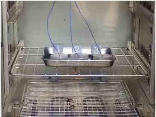
【写真 26 熱電対の設定状況】
