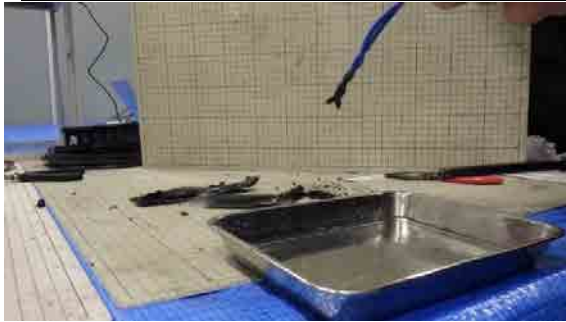
【写真 10 青色配線（難燃性）】
