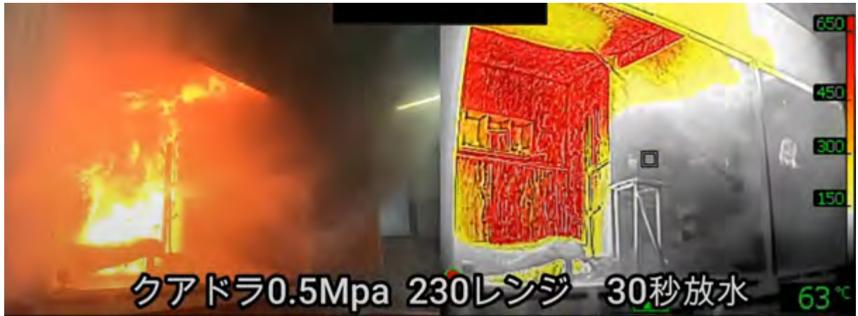
写真 16 ガンタイプノズル放水
