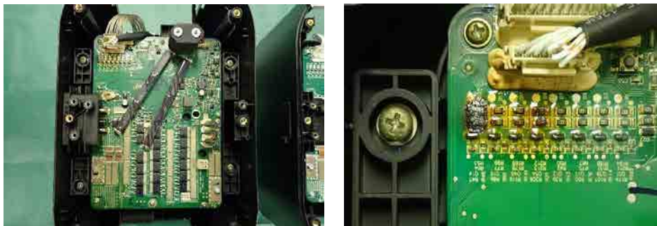
写真 9 BMS 基板天面側
