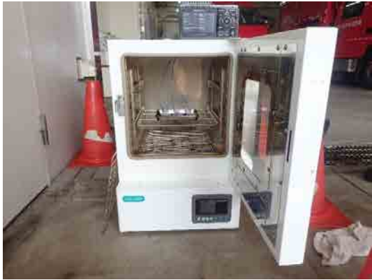
【写真 25 定温乾燥機内の配置状況】
