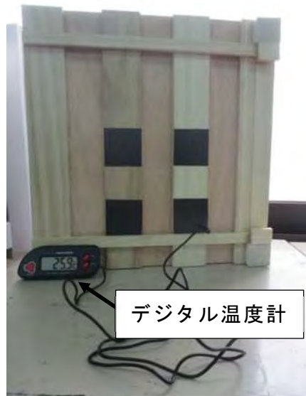
（写真 2） 模型の裏側及びデジタル温度計
