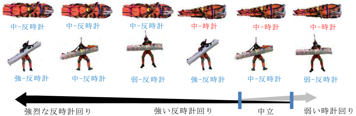
図 25 収容方法及び収容位置の変位に伴う回転方向と回転力強弱
