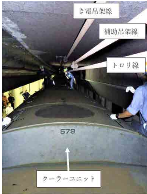
【写真1 5号車屋根の状況】
