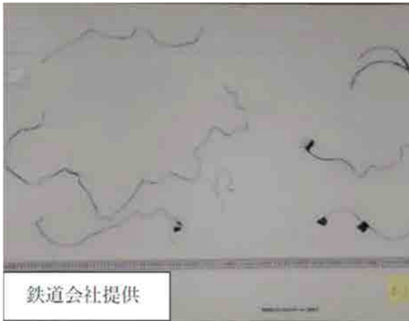
【写真 14 回収したバリの状況】
