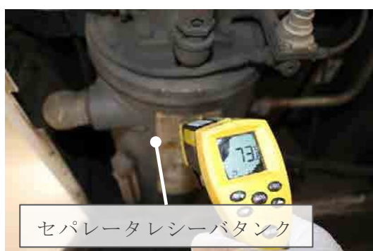
写真7 コンプレッサ内の温度測定
