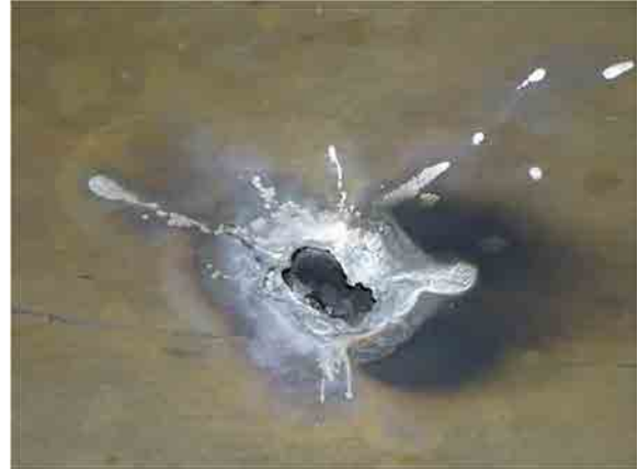
【写真5 クーラーカバー外面の溶融痕】
