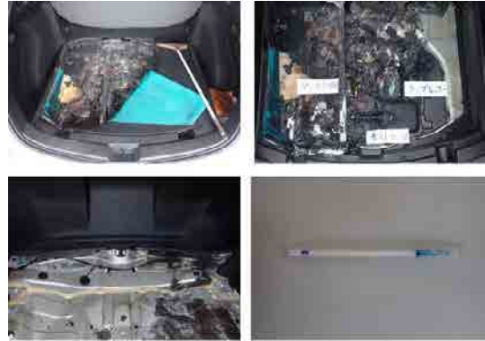
写真 5 荷室内焼損状況及びガス採取結果
