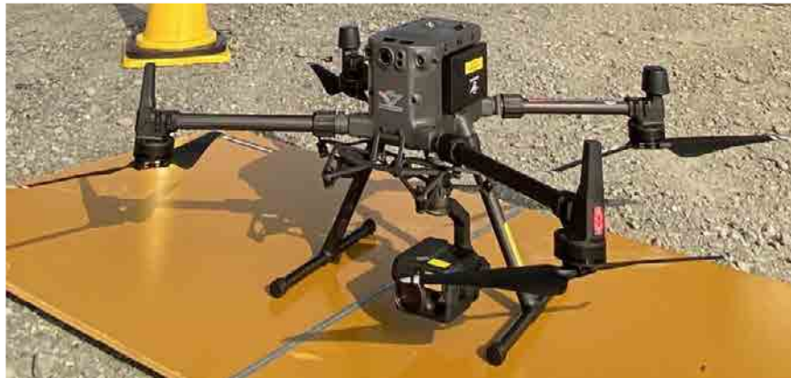
図2 自動飛行が行える汎用的な産業用ドローン
