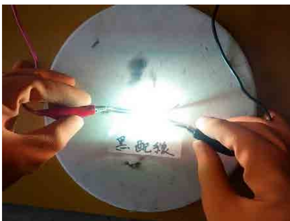
【写真 32 短絡の燃焼実験 1】
