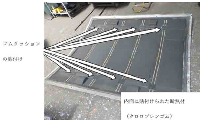
【写真 11 同等品のクーラーカバー内面の状況】
