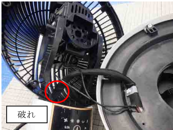
【写真14 同型品の配線状況】
