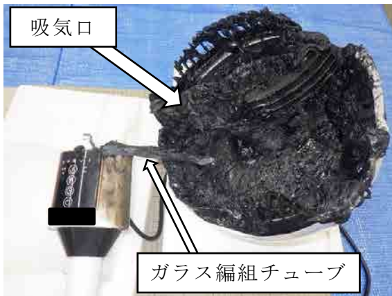
【写真2 可動部吸気口側】
