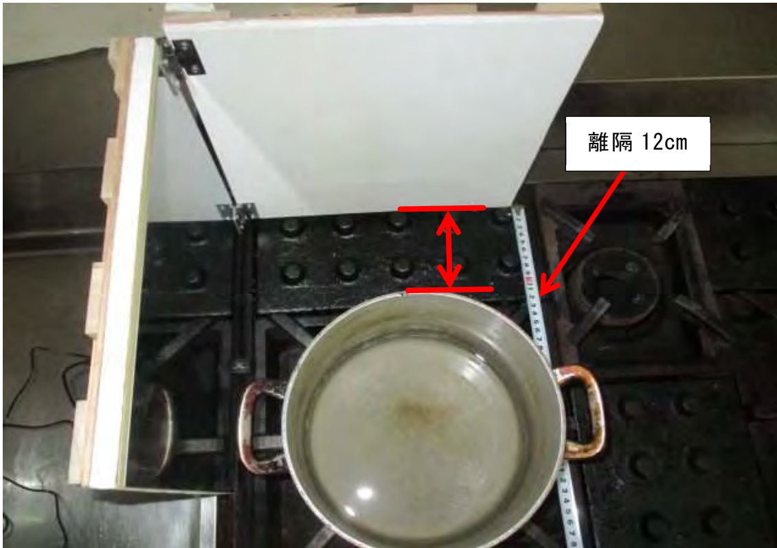
（写真 5）類似する仕上げの面に 12cm の離隔距離を確保した状況
