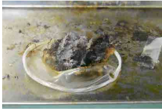
【写真 32 実験No.4 ウェスの炭化の進展状況】
