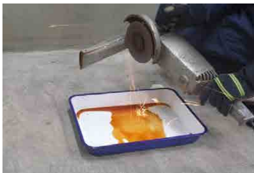
写真 21 オイルにグラインダの火花を接炎した状況
