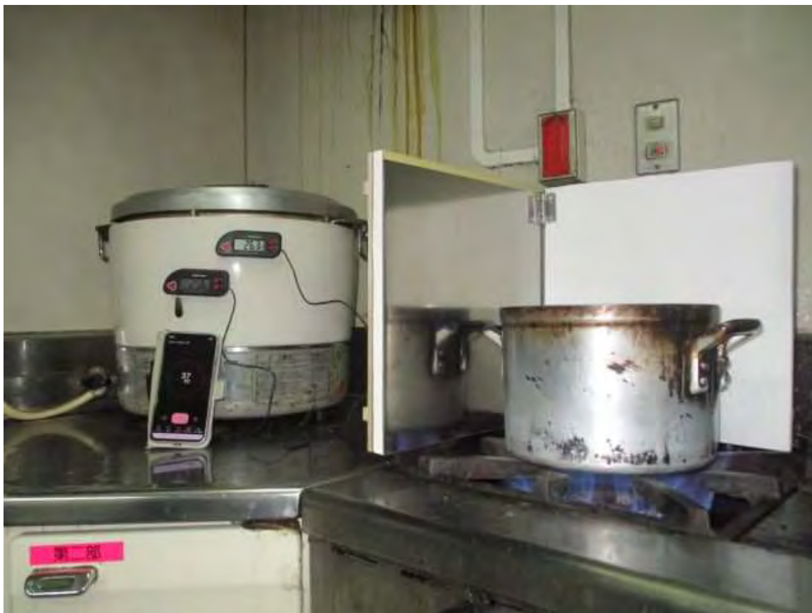
（写真 4）業務用ガスこんろを使用し、温度計測を実施している状況
