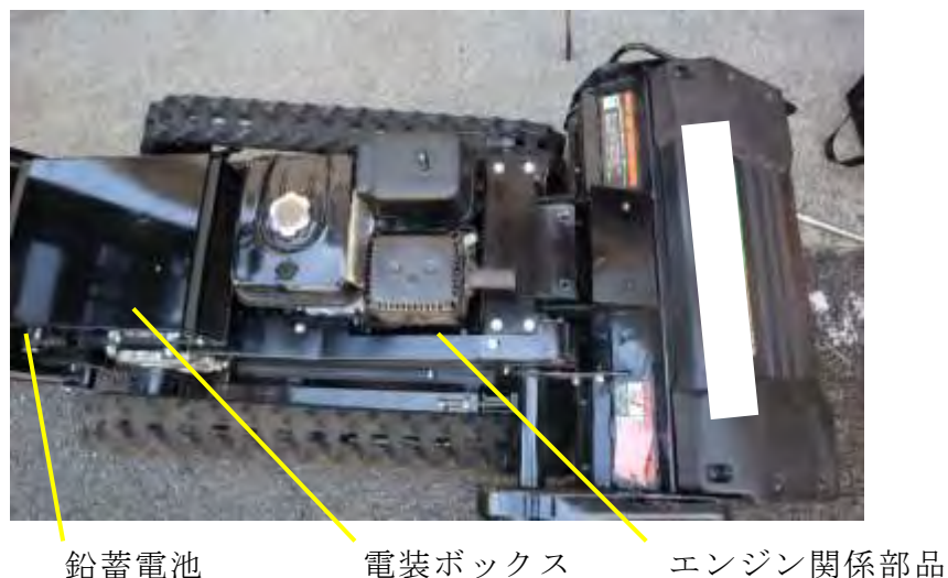
【写真 4 ラジコン草刈機（同型機）の外装カバー及びフレームを取り外したものの】
