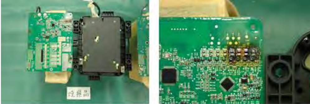
写真 11 BMS 基板底面側
