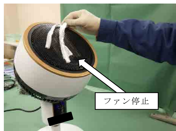
【写真17 同型品のファン稼働停止状態】
