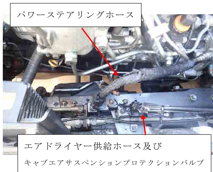
写真2 焼損車両の状況
