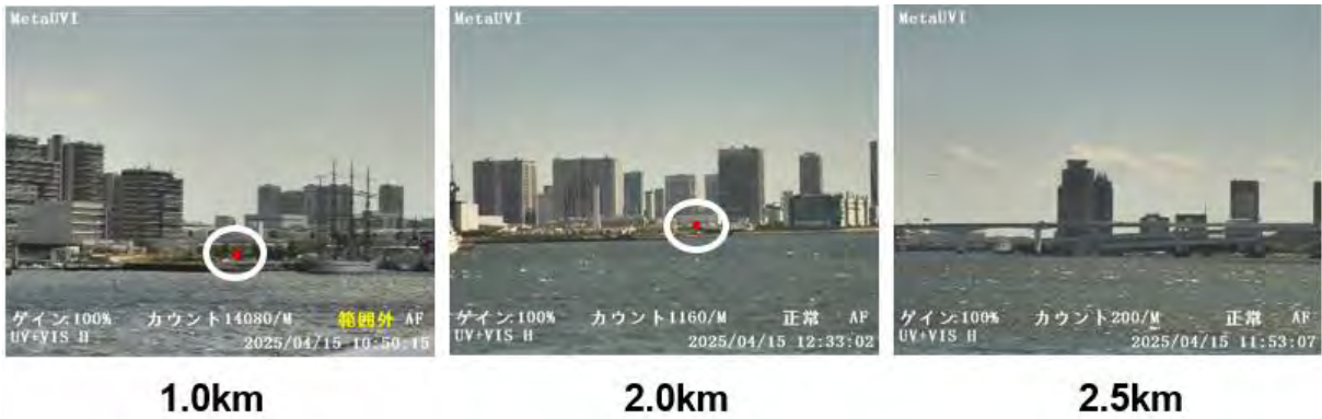
図 4 模擬海上搜索試験結果
