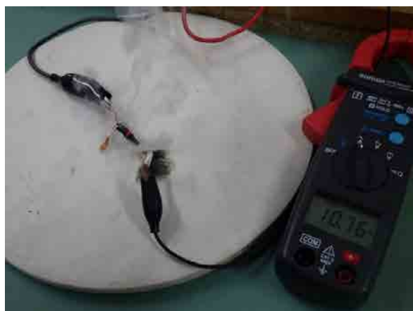
【写真 36 半断線の燃焼実験（発煙）】
