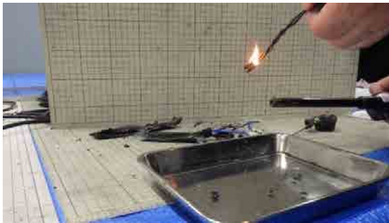
【写真 12 黒色配線（可燃性）】
