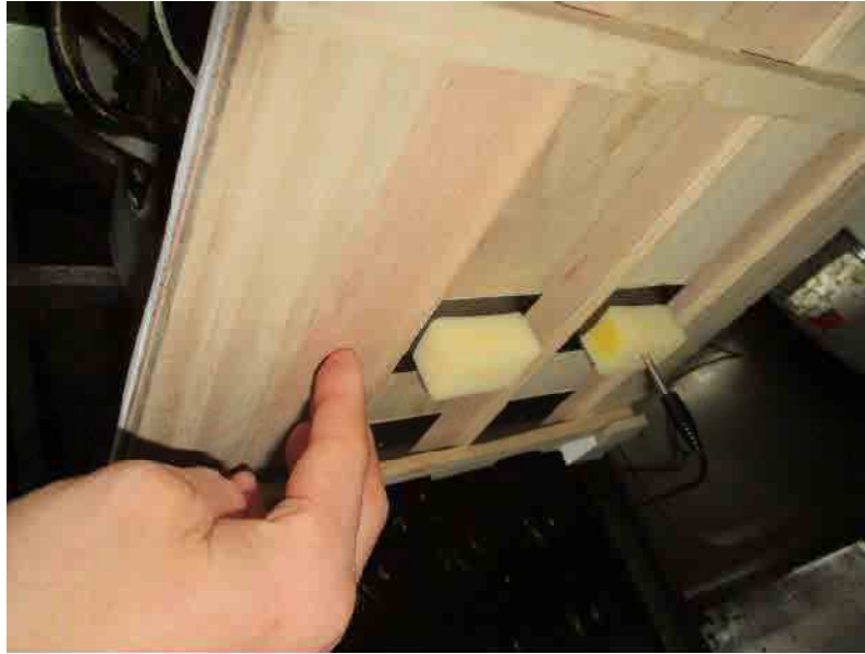
（写真 6）模型裏面を手で触れて壁体内部の温度を確認している状況
