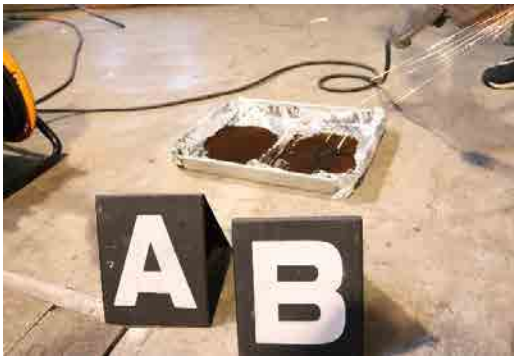
写真 15 グラインダの接炎状況
