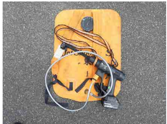
写真2 電動式消火シューター
