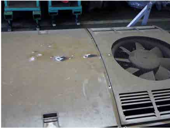
【写真4 クーラーカバー外面の溶融痕の状況】
