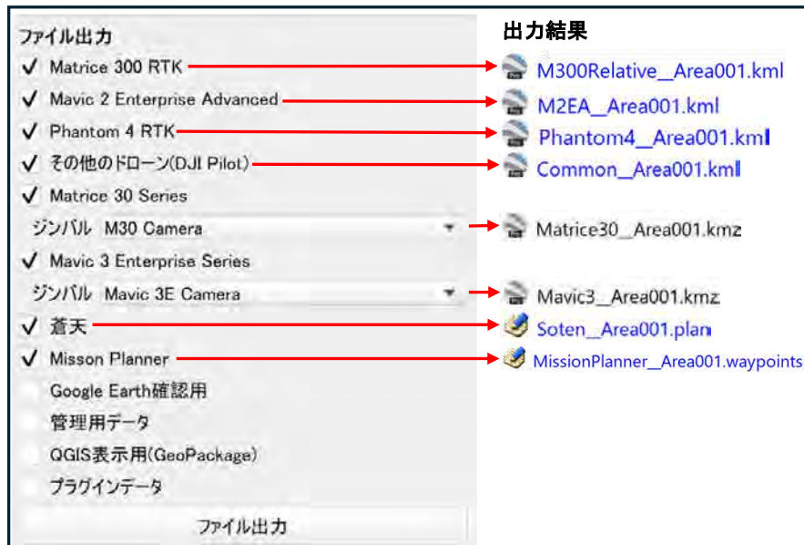
図7 複数のメーカーの機体に対応した飛行計画の出力機能
