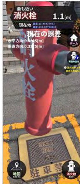
図 3.6 消火栓位置の視覚的確認
