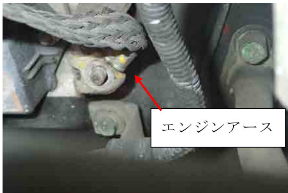
写真4 エンジンアースの状況
