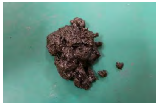
写真 20 コンプレッサ内の残渣物
