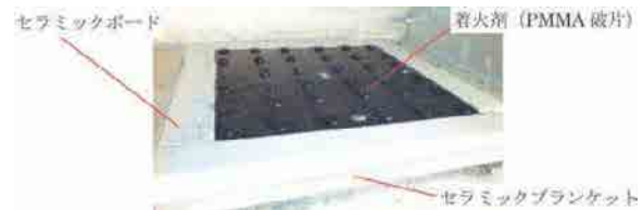
図3 PMMAと着火剤の設置状況
