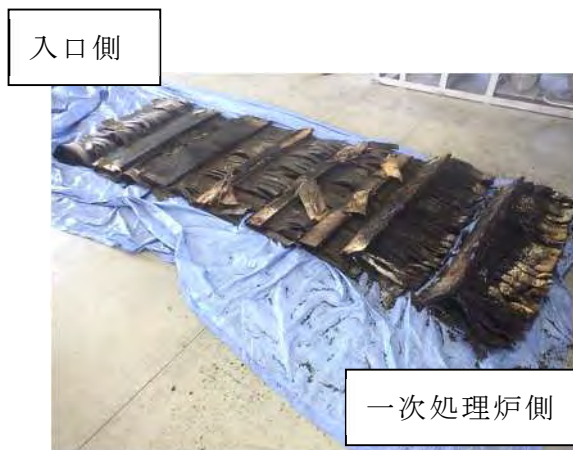
【写真8 メタルカーテンの状況】
