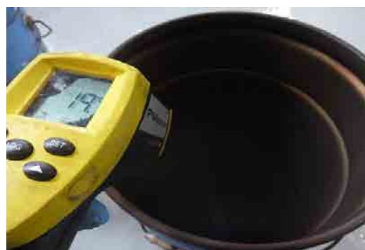
写真8 集塵機鉄粉の温度測定
