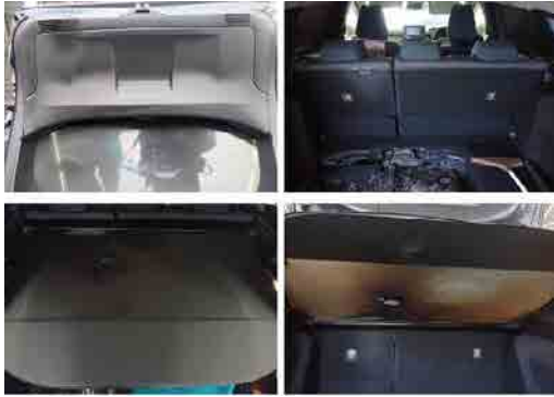
写真 4 荷室内焼損状況
