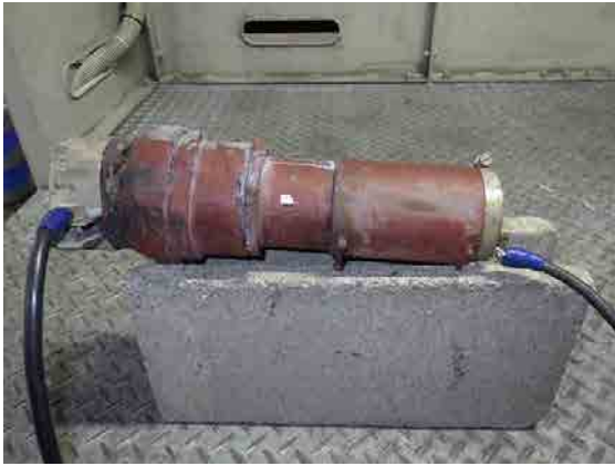
写真 10 低圧短絡試験装置による通電試験
