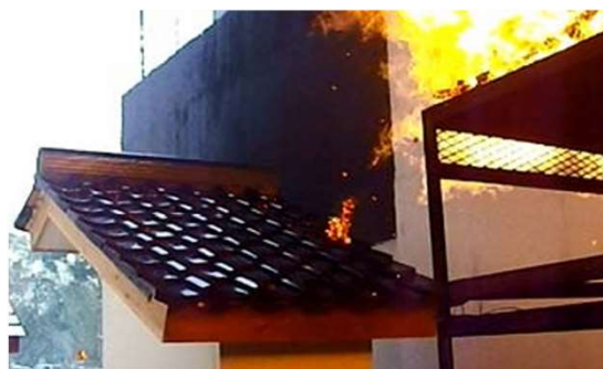
瓦屋根に対する飛び火の検証例
