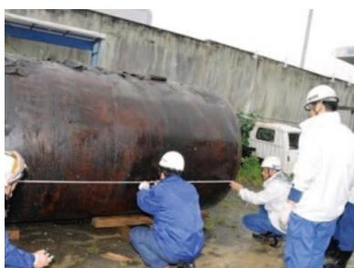
給油取扱所地下タンクの腐食調査(○印が腐食部)
