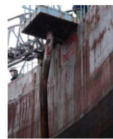
ゲージポールの変形、スロッシング波高約1.4m
