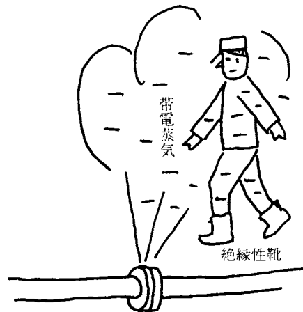
図2 配管から噴出する水蒸気は帯電しており、その中を通りぬけたゴム靴を履いた人は帯電する。
