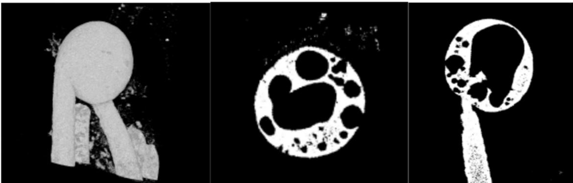
熔融痕を白色 X 線 CT 測定後に解析した結果の例 (切り取った状態で通電により作成した試料、左から立体表示、横方向の断面図、縦方向の断面図) (P.53)
