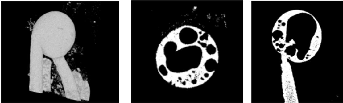
図 2 溶融痕を白色 X 線 CT 測定後に解析した結果の例
