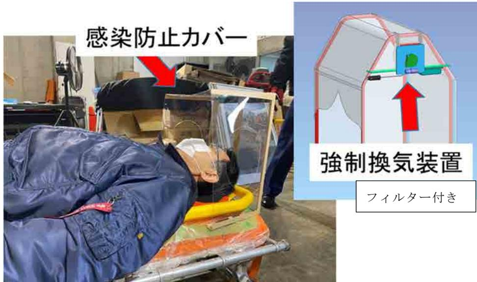
図8 感染防止カバーの試作機
