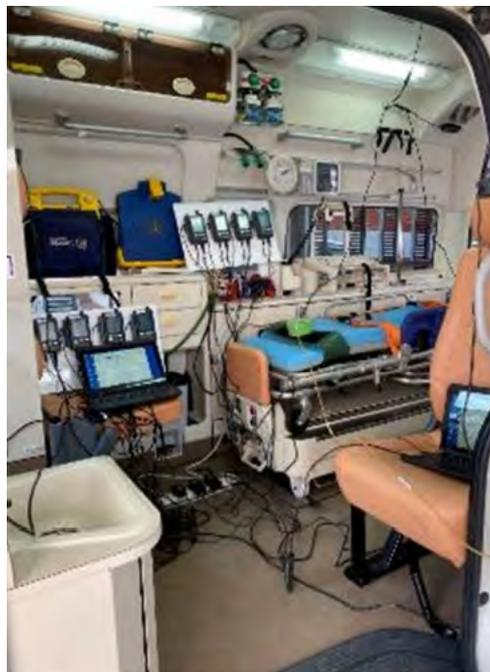
図 19 寒冷地での救急車内気流測定（救急車内の測定状況）
