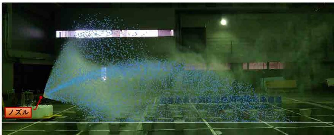
噴霧放水時の放水シミュレーションと放水実験との比較 (両結果を重ね合わせて表示) (P.85)
