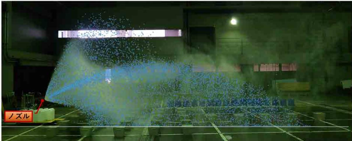
図1 噴霧放水時の放水シミュレーションと放水実験との比較(両結果を重ね合わせて表示)
