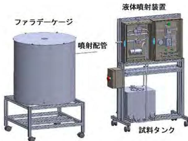
図 3 衝突帯電を測定する実験装置の概念図
