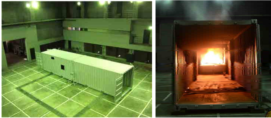
写真2 消防隊放水実験用区画
