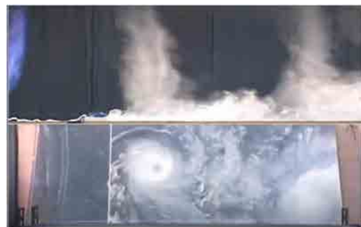
写真2 火炎を含まない火災旋風： 側面からと、鏡越しに下からと 同時に撮影した映像
