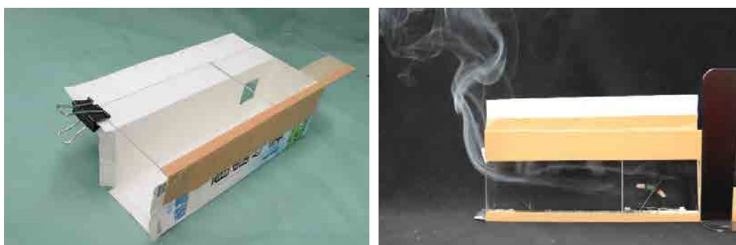
写真 1 牛乳パックを使った簡易燃焼区画
