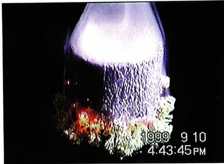
写真1 ナトリウム酸化物表面での火炎伝播
