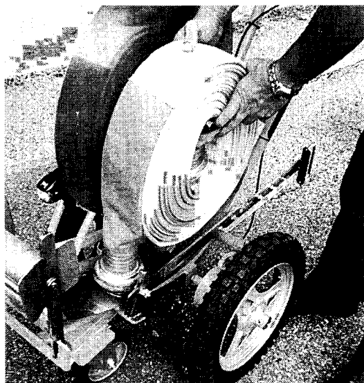
写真5 ホースを取り外している状況
