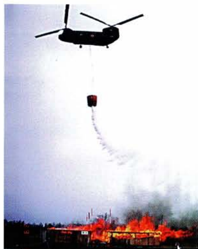
写真4 大型ヘリコプター(CH-47)による空中消火実験(本文p.27)
