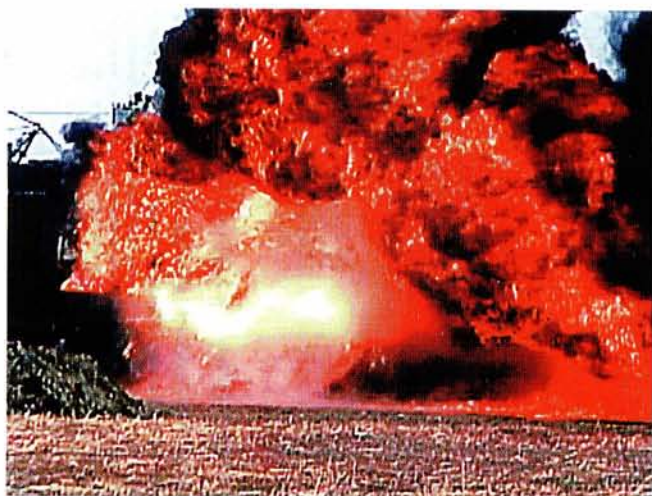
写真3 大規模な原油のボイルオーバー実験 中央にファイアーボール状の輝炎が生じ、風下側タンク直径の約6倍(30m)にわたり原油が飛散(本文p.46)
