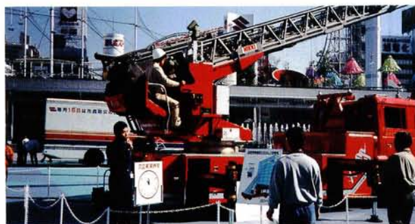
写真3 自動架梯装置付きはしご車
