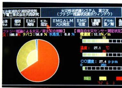
↓写真-2 ファジー推論状況のCRT画面表示例
