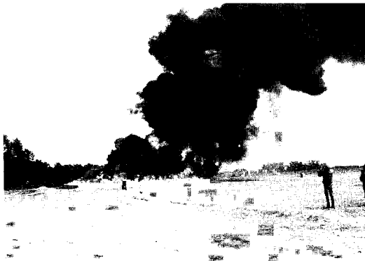
図1 15m角容器での原油燃焼実験の様子
