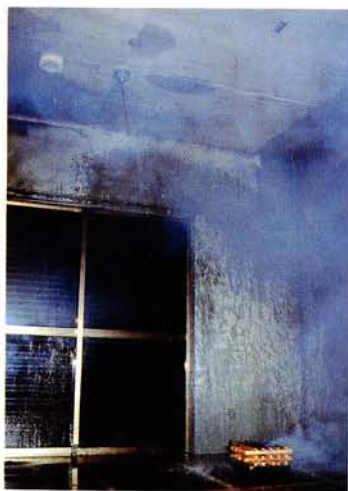
写真-3 家庭用簡易スプリンクラーの散水試験
