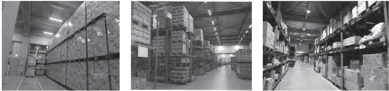
図 2.1 物品の主な積み方の例 (左:平置き、中:ネステナー、右:パレットラック)
