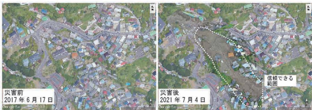
図4 7月4日に合同調整所に提供したオルソ画像(被災地中流部の一部地域) (左・Google Earth 画像, 右・オルソ画像を Google Earth 画像に重ね合わせ)
