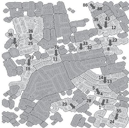
図 14 メッシュ内で計算した延焼クラスタ間延焼の例 (メッシュ 0305 風向:北 風速:12m/s)
