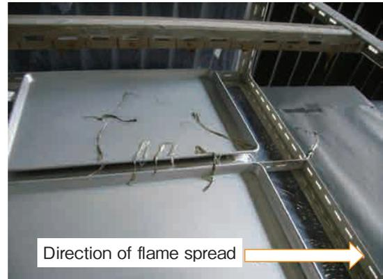
火炎伝ば後の様子 実験 c1 試料の種類 ポリ塩化ビニルシート
