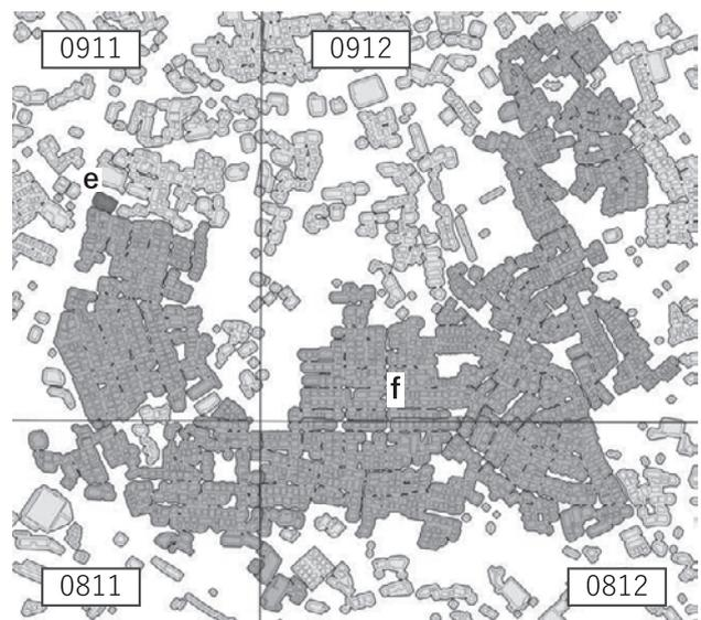
(2) 既報の計算手法により構築された延焼クラスタの例
